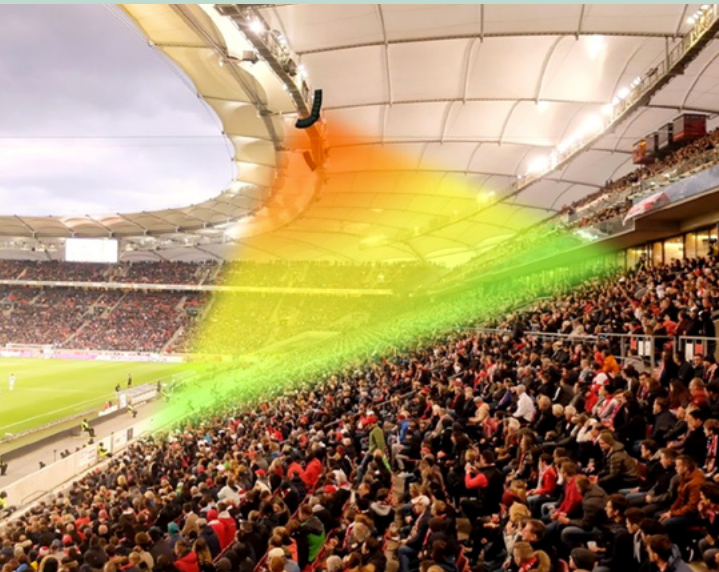
Abbildung 7: Typische Abstrahl- charakteristik im Schnitt (Tribüne – Unterrang)
