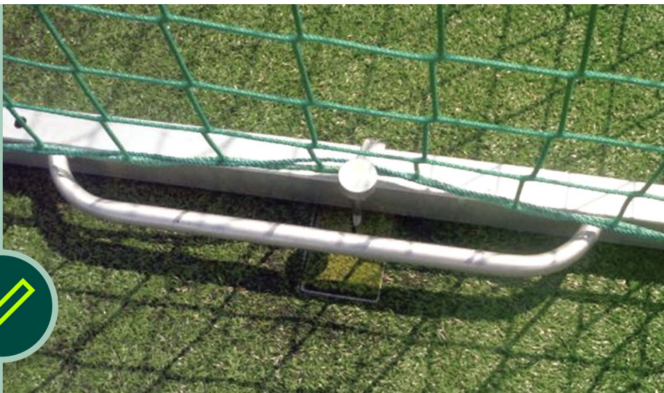
Bild 3: Tor-Typ 3 mit Bodenbefestigung, hier: Spiralanker bei der Sportgeräteinspektion vor Ort. In diesem Fall wurden die Anforderungen an Standfestigkeit und Festigkeit gemäß DIN EN 748 erfüllt.
