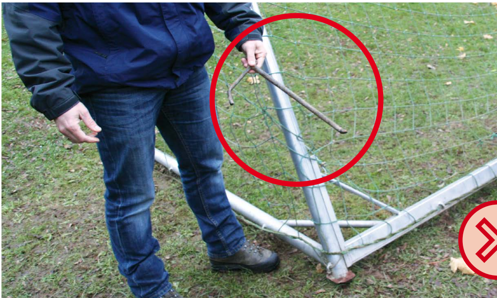
Bild 38: Dieses Tor ist ungesichert. Dieser Haken ist vermutlich nicht ausreichend, um das Tor standsicher zu verankern.
