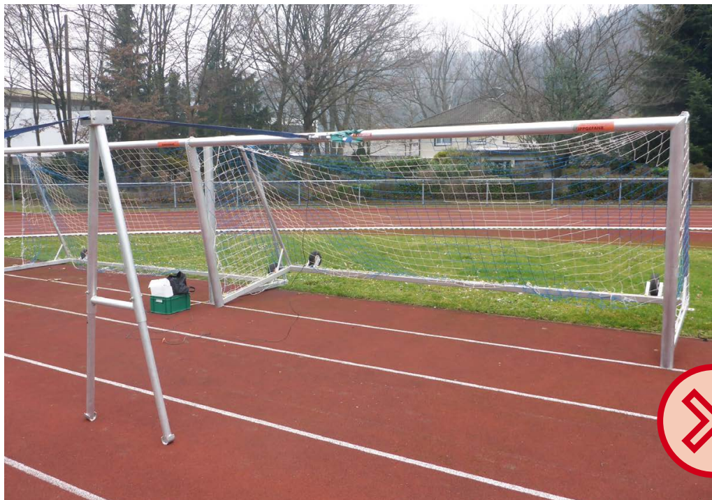
Bild 7: Wenn sich das Tor bei der Standfestigkeits- und Festigkeitsprüfung gemäß der sicherheitstechnischen Anforderungen nach DIN EN 748 hebt, ist die Standfestigkeit nicht ausreichend.
