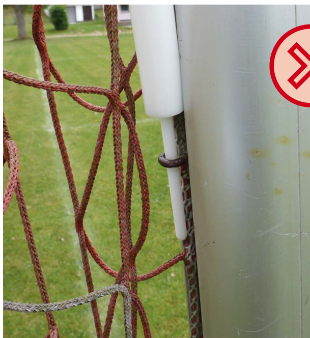
Bild 32: Die kleine Seite des Prüfstabes passt in die Öffnung, d.h. diese ist größer als 8 mm, aber eindeutig kleiner als 25 mm und daher nicht zulässig.
