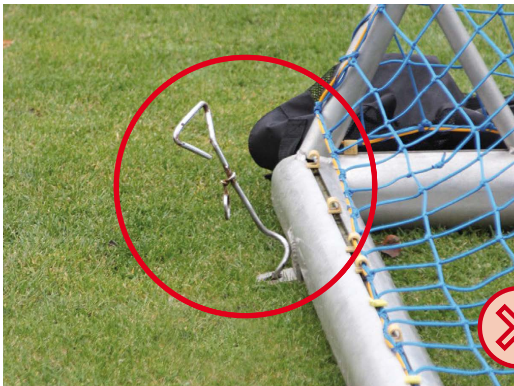
Bild 9: Überstehender, nicht vollständig eingeschraubter Spiralanker
