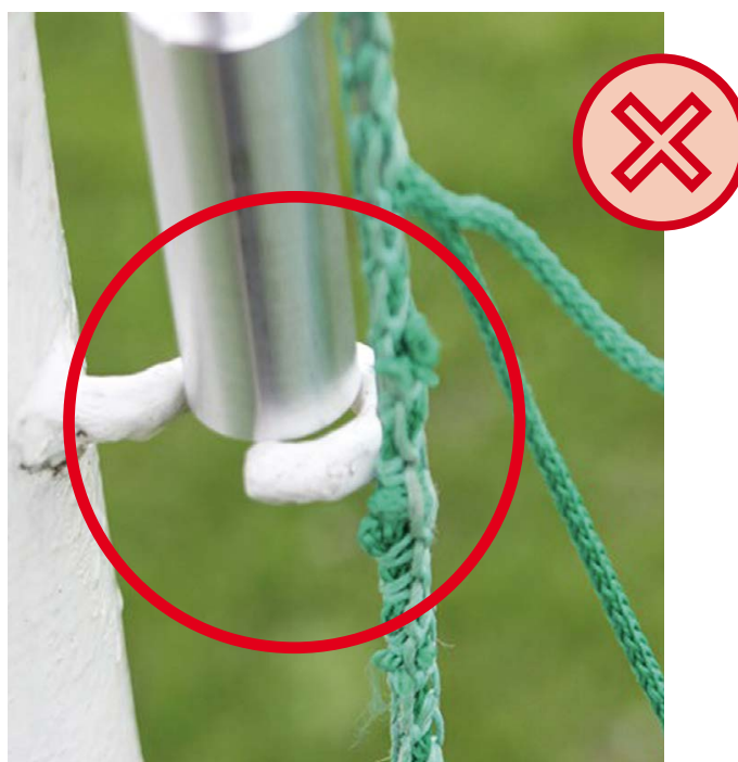
Bild 34: Offener Metallnetzhook mit Öffnung < 25 mm. Die große Seite des Prüfstabes passt nicht in die Öffnung, d.h. diese ist kleiner als 25 mm und daher ebenfalls nicht zulässig.
