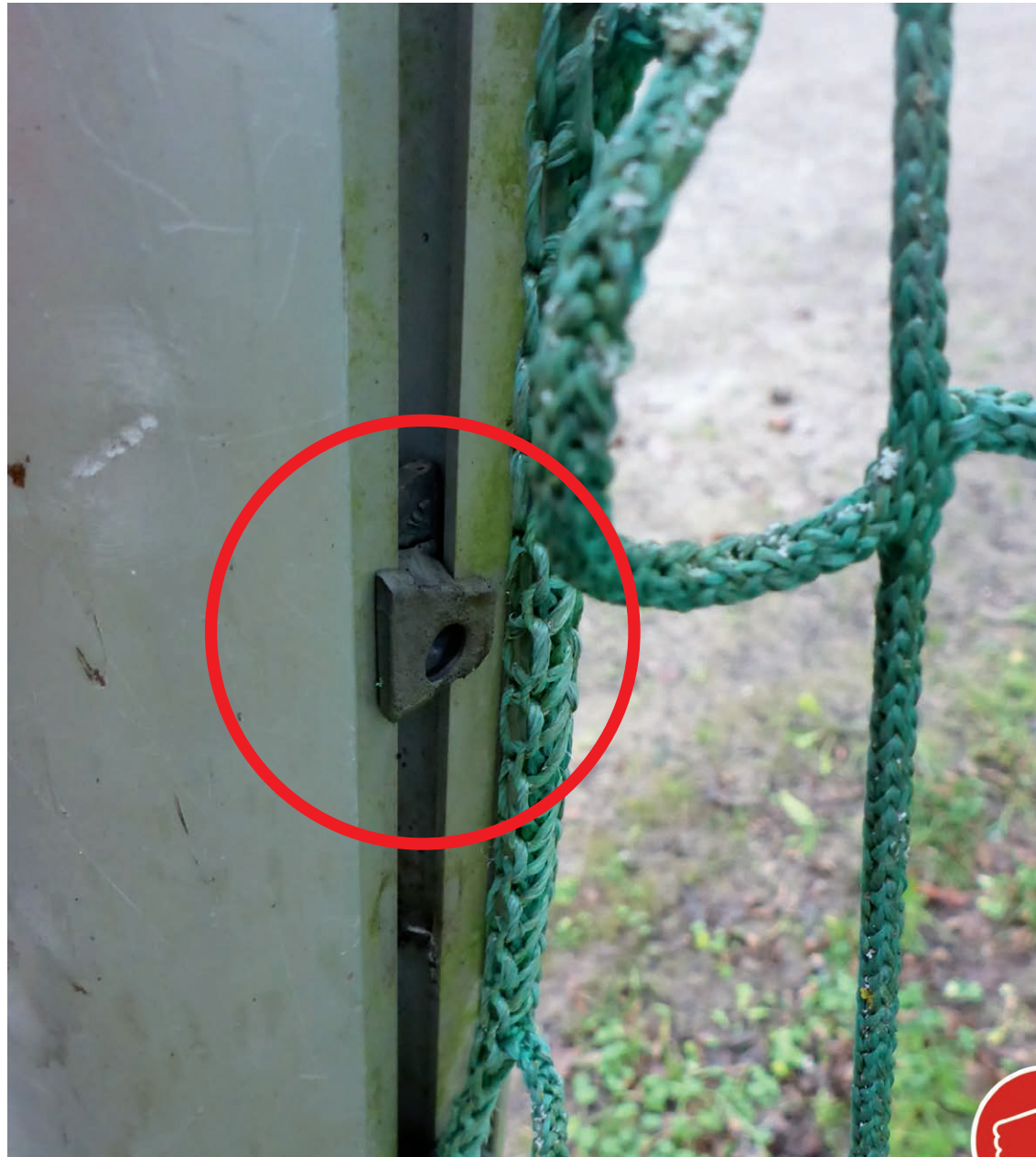
Bild 33: Gebrochene Kunststoffnetzaken sind auszutauschen.
