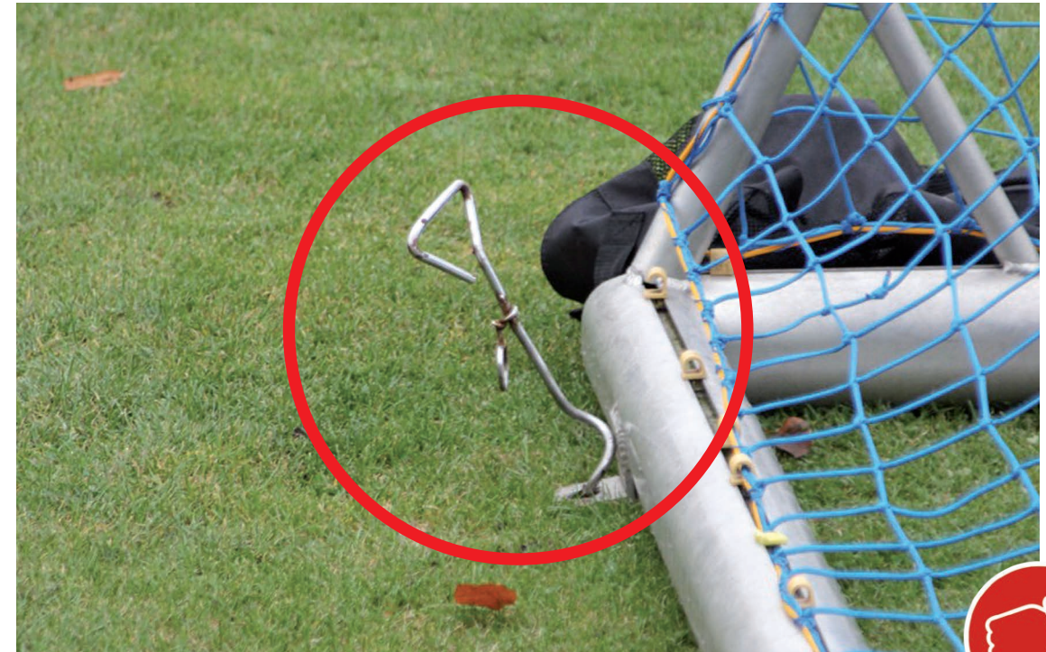
Bild 9: Überstehender, nicht vollständig eingeschraubter Spiralanker
