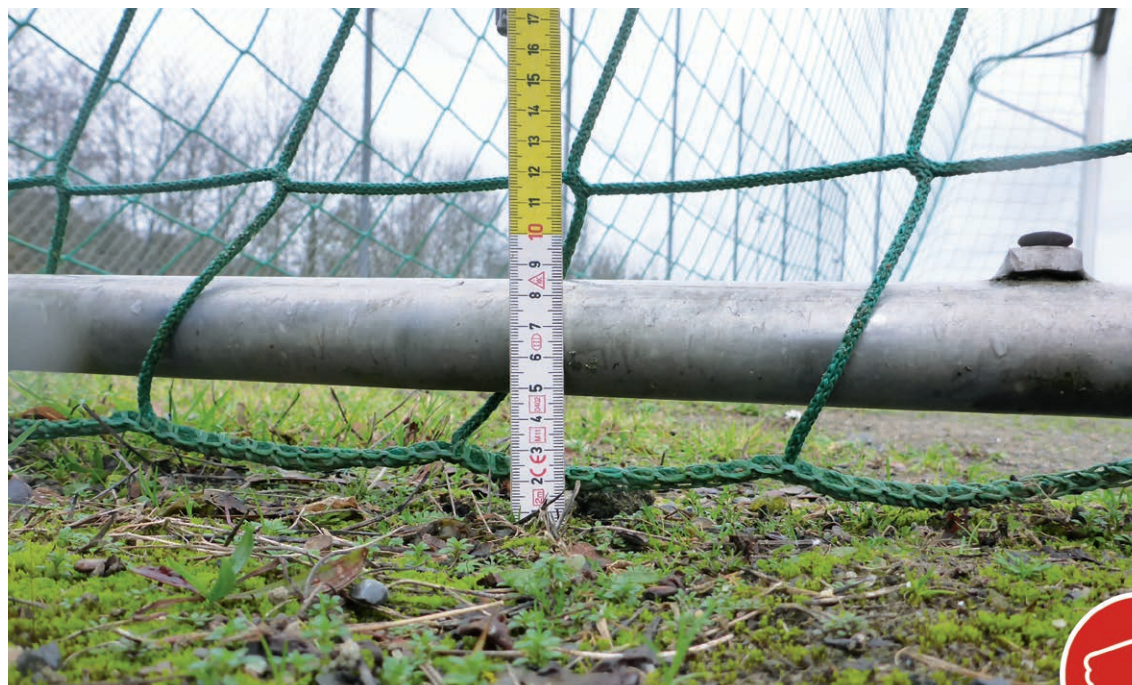
Bild 24: Höhendifferenz zwischen Bodenrahmen und Boden
