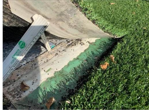
Abb. 6: Fehlerhaft ausgebesserte Klebung
