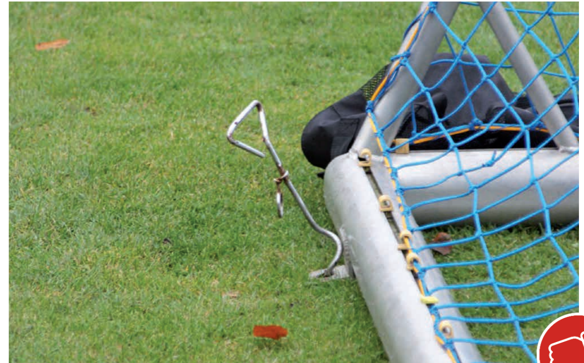
Bild 9: Überstehender, nicht vollständig eingeschraubter Spiralanker
