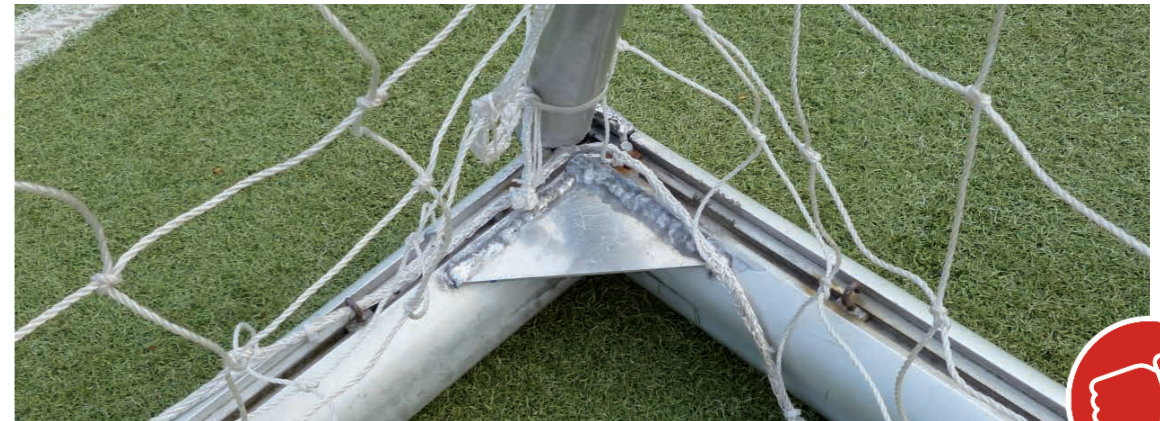
Bild 28: Eingeschweißter Winkel stellt erhöhte Verletzungsgefahr dar
